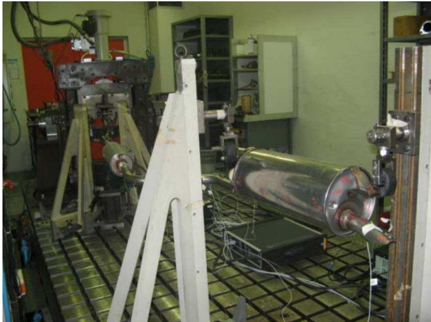
図2 テスト・ベンチに固定された排気系
